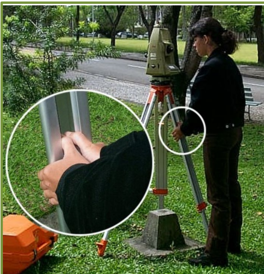
ajuste do nível de bolha através dos movimentos de extensão do tripé
