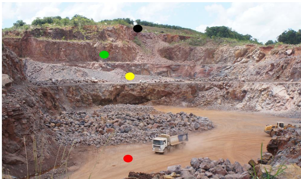
Figura 31. Visão geral da cava ativa da pedreira, com seus respectivos patamares destacados (vermelho = PMU 4, amarelo = PMU 5, verde = PMU 6 e preto = PMU 7). É possível observar um sutil dobramento das porções, com caimento para dentro do plano da foto. Nos metarenitos do patamar 6 é possível uma melhor visualização das estruturas de dobra.
