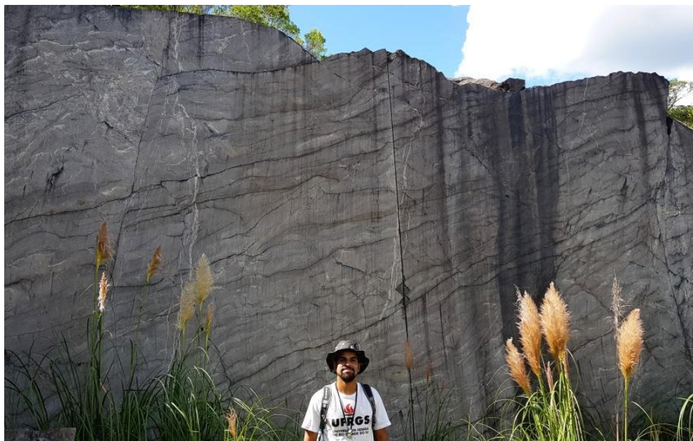
Figura 26. Porção inicial da seção de mármore do projeto (PMU 3), em bloco do Mármore Mudador cortado por serra diamantada. É possível verificar uma série de feições em virtude do corte lateral: A S_0 ocorre inclinada em aproximadamente 40^\circ , com zonas de intensa venulação de material branco, brechação hidráulica e feições globulares a ovais em cinza claro, podendo remeter a registros de organismos marinhos (feições estromatolíticas e/ou trombolíticas).
