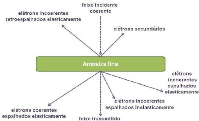
Figura 3-9: Processos de espalhamento sofridos por elétrons ao interagir com a amostra.
