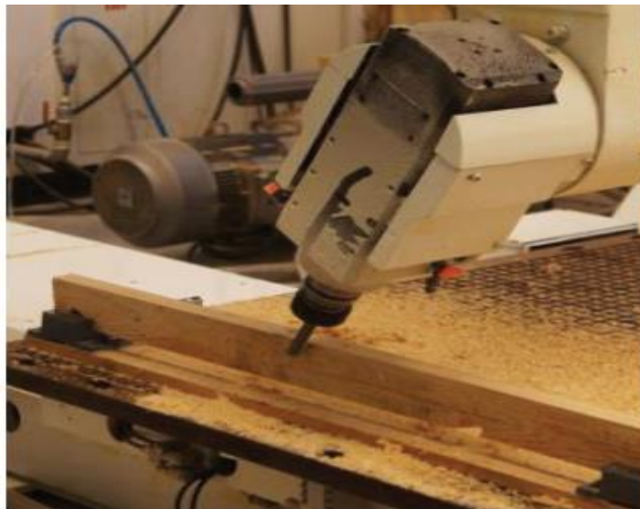
Figura 263 – Fresagem das hastes em fresadora CNC de 5 eixos
