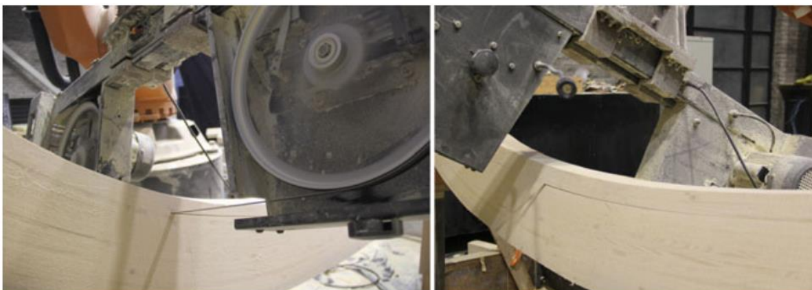
Figura 347 - Corte robótico com serra em fita acoplada em funcionamento
