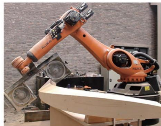
Figuras 335 – a) Processo de produção das vigas de borda, à esquerda; b) Produção com auxílio do braço robótico com a serra fita acoplada, à direita
