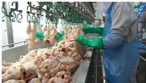
Figura 10. Setor Chiller – Rependura do frango na nória.
