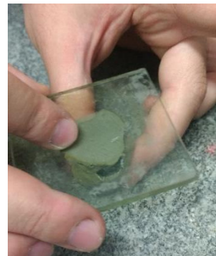
Figura 21 - Rasamento do corpo de prova
