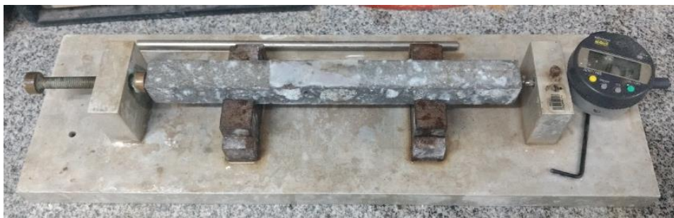
Figura 17 - Aparato de medição dos corpos de prova
