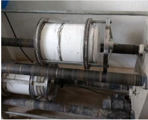
Figura 6 - Moinho de bolas utilizado para moagem
