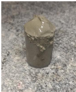
Figura 20 - Pasta de cimento para o acabamento superficial
