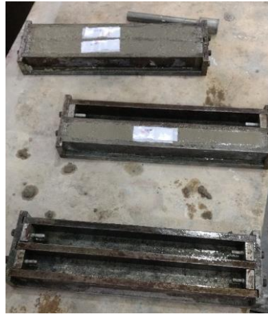
Figura 13 - Barras de argamassa para ensaio de Reação Álcali-Agregado
