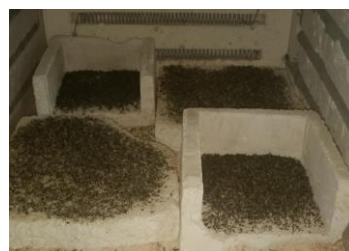
Figura 5 - Cascas de aveia ao sair do forno mufla
