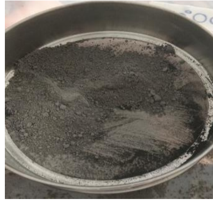
Figura 7 - Peneiramento das cinzas
