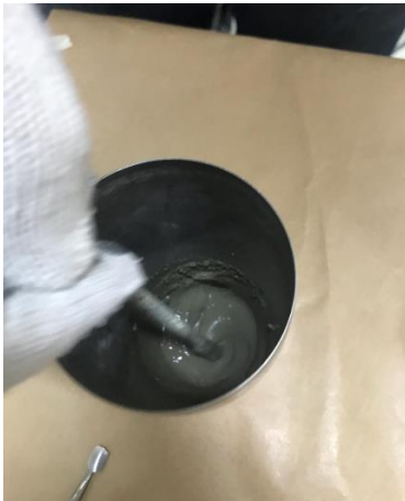
Figura 8 - Mistura manual da pasta de cimento
