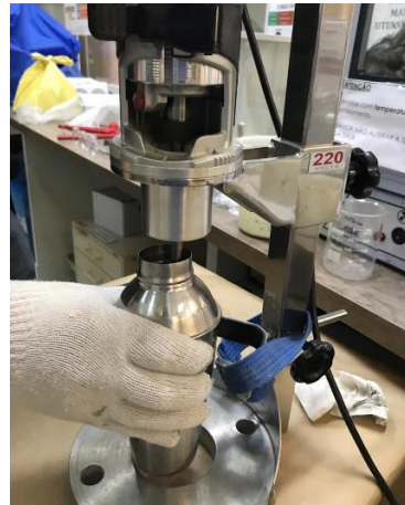
Figura 9 - Mistura mecânica da pasta de cimento
