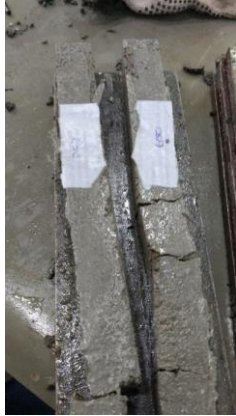
Figura 14 - Desmolde de corpos de prova com problemas de cura
