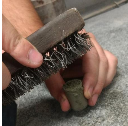
Figura 19 - Escovação do topo do corpo de prova
