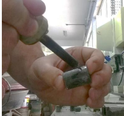
Figura 22 - Corte do molde do corpo de prova
