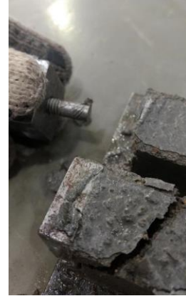
Figura 15 - Pino do corpo de prova com problemas de ancoragem
