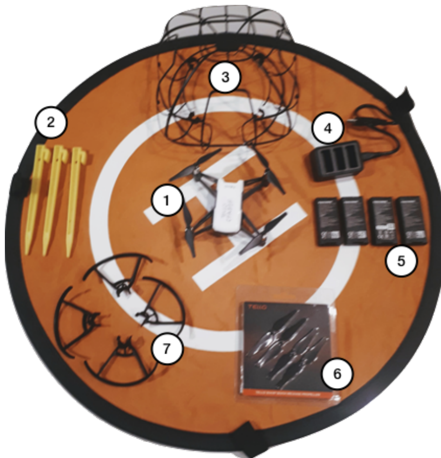
Figura 19 - Kit para as oficinas com drones composto por: 1 -Drone Tello Ryze Tech / DJI; 2 -Drone Landing Pad de 55cm com estacas para fixação externa; 3 -Gaiola protetora PGY-Tech; 4 -Carregador de baterias Tello; 5 -Baterias Tello Fullymax; 6 -Hélices sobressalentes; 7 – protetores de hélice.
