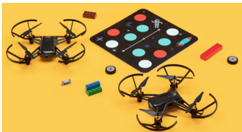
Figura 18 - Dois Drones Tello EDU com um Mission Pad, produzidos pela empresa chinesa Ryze Tech com tecnologia DJI.
