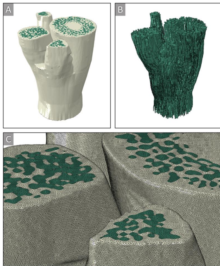
Figura 34 – Processo de discretização para a FEA baseada na \mu CT: (A) modelo de montagem discretizado com as regiões do parênquima (branco) e esclerênquima (verde); (B) região do esclerênquima apenas, ao esconder os elementos de malha do parênquima; e (C) detalhe da malha de elementos tetraédricos da montagem. Os contornos dos elementos foram escondidos em A e B para melhor visualização.
