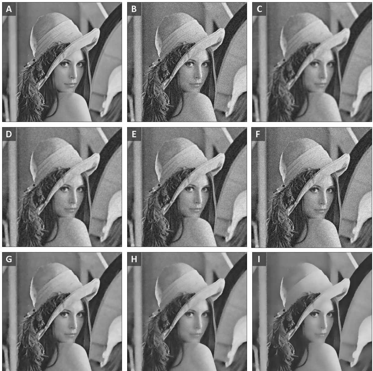
Figura 13 – Exemplo de aplicação de filtros para remoção de ruído: (A) imagem original; (B) imagem com ruído utilizada como base; (C) filtro de suavização linear; (D) filtro de mediana; (E) filtro Sigma Plus ; (F) filtro Kuwahara; (G) filtro de difusão anisotrópica; (H) filtro bilateral; e (I) filtro de médias não-locais.
