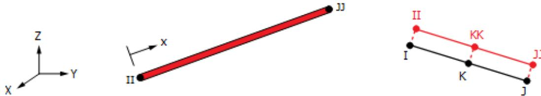
Figura 4.3: Sistema de coordenadas e geometria do elemento REINF264 (Adaptado de: ANSYS, 2009).
