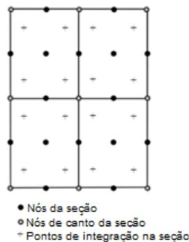
Figura 4.2: Indicação dos nós e pontos de integração na seção transversal do elemento (Adaptado de: ANSYS, 2009).
