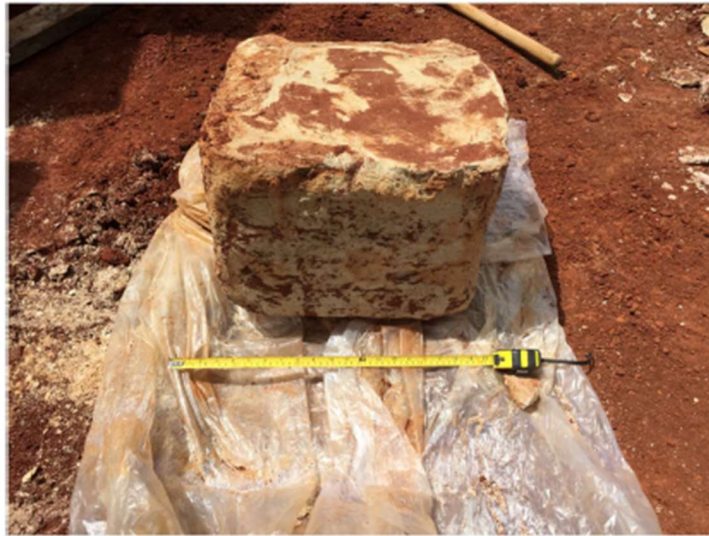
Figura 2. 34: Camada (450 mm de aresta) exumada após o ensaio de campo (CONSOLI et al., 2019).
