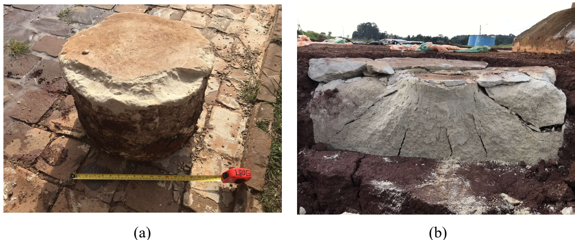
Figura 4. 13: (a) ruptura por puncionamento ( H_r/D = 1,00 - T_r/H_r = 0,25 - \eta/C_{iv} = 17 ); (b) ruptura no reforço ( H_r/D = 1,00 - T_r/H_r = 1,00 - \eta/C_{iv} = 17 ).
