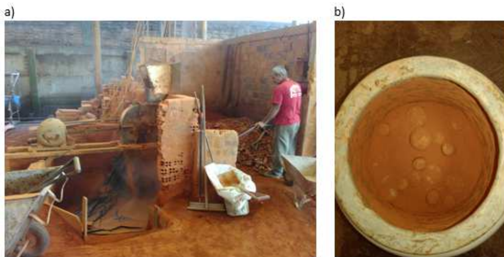
Figura 3-5. Tratamiento de los RCV. a) Molino de martillo. b) Molino de bolas.
