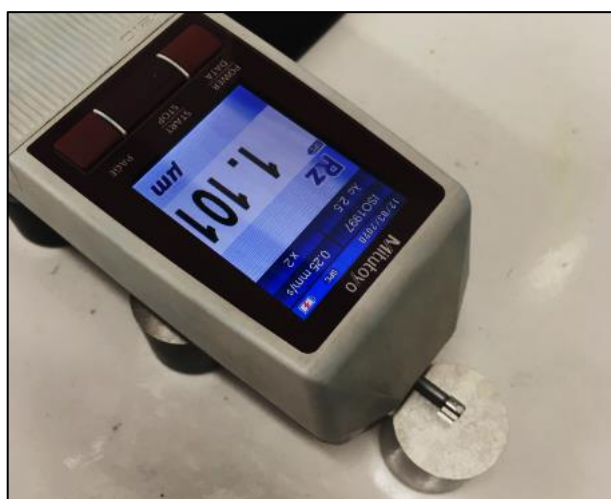
Figura 36 - Medição da rugosidade
