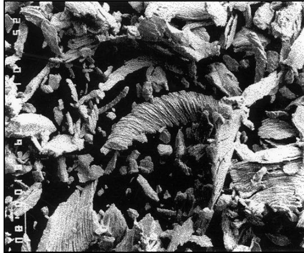
Figura 15 - Detritos provenientes de um tipo severo de desgaste abrasivo
