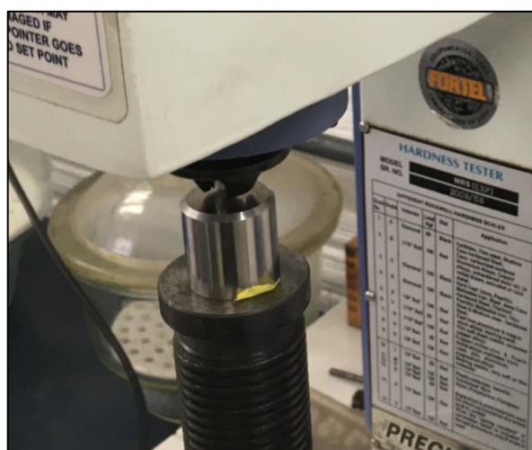
Figura 35 - Medição da dureza de um disco
