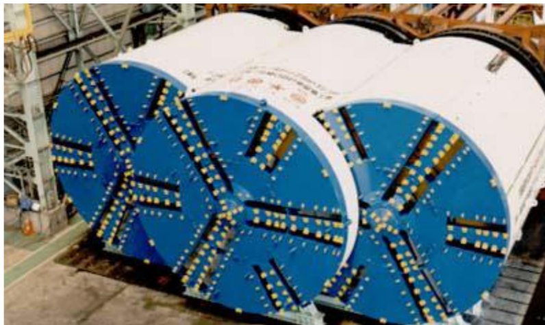
Figura 3.5 - Tuneladora com seções acopladas (VOJKOVSKÝ, 2013)
