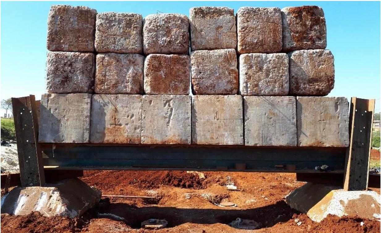
Figura 3.16. Sistema de reação utilizado nas provas de carga
