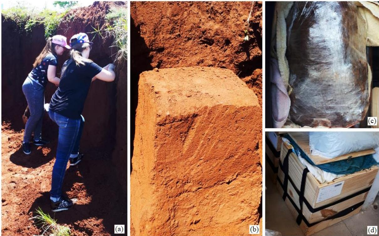
Figura 3.1. (a) Retirada manual do bloco indeformado, (b) Bloco indeformado de solo, (c) Colocação de papel filme e (d) Acondicionamento da amostra.
