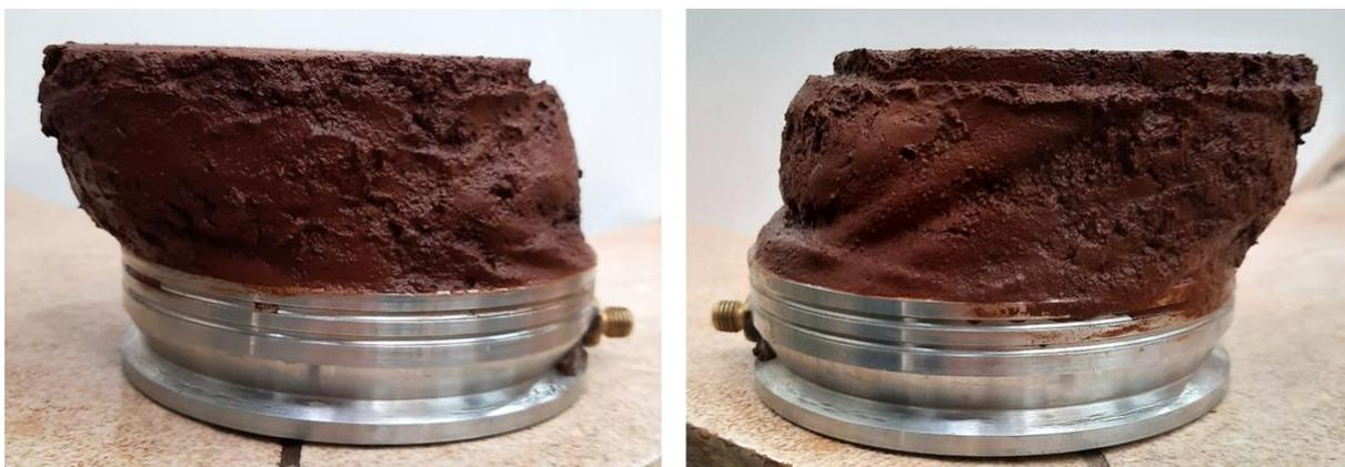
Figura 4.9. Forma de ruptura da amostra de solo coesivo friccional de Passo Fundo submetida a ensaio *Simple Shear* cíclico com tensão efetiva inicial de 50 kPa e tensão cíclica máxima 40%  $\sigma'_{vi}$ .
