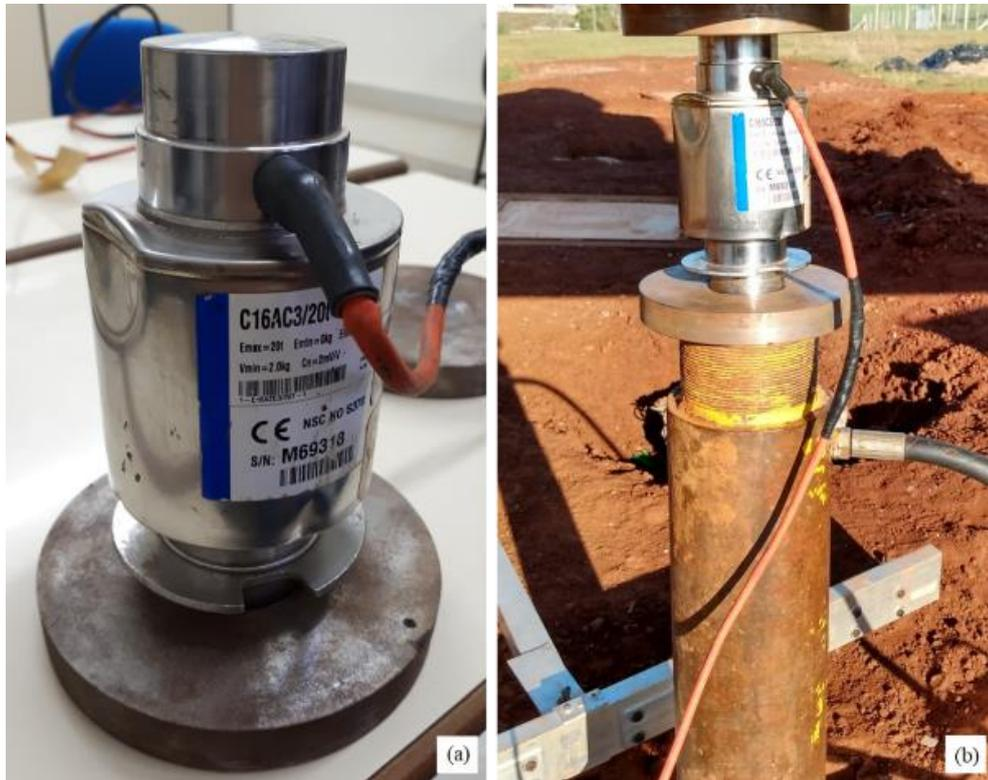
Figura 3.18. (a) Detalhes da célula de carga e (b) Posicionamento da célula de carga durante os ensaios
