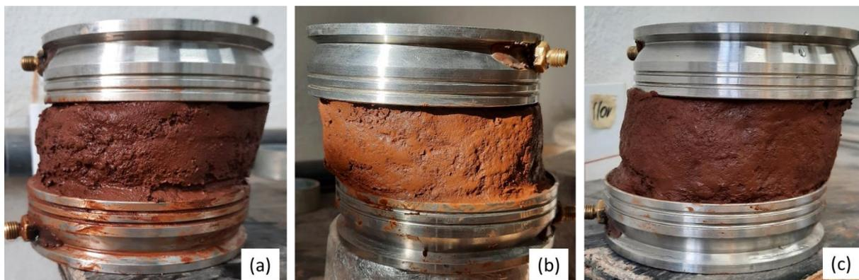
Figura 4.6. Forma de ruptura das amostras de solo coesivo friccional de Passo Fundo submetidas a ensaios *Simple Shear* com tensões efetivas iniciais: (a) 50 kPa, (b) 35 kPa e (c) 20 kPa.
