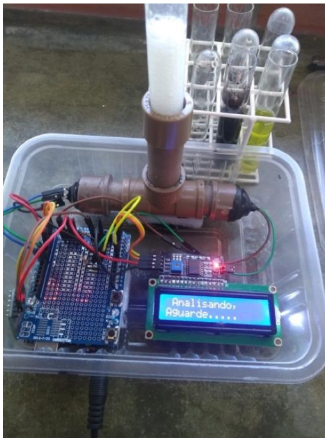
Figura 23 - Análise do pH da amostra utilizando o repolhómetro.
