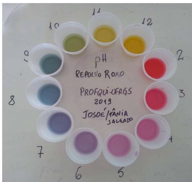
Figura 15 - Variação das cores de soluções do extrato de repolho roxo em função do seu pH.
