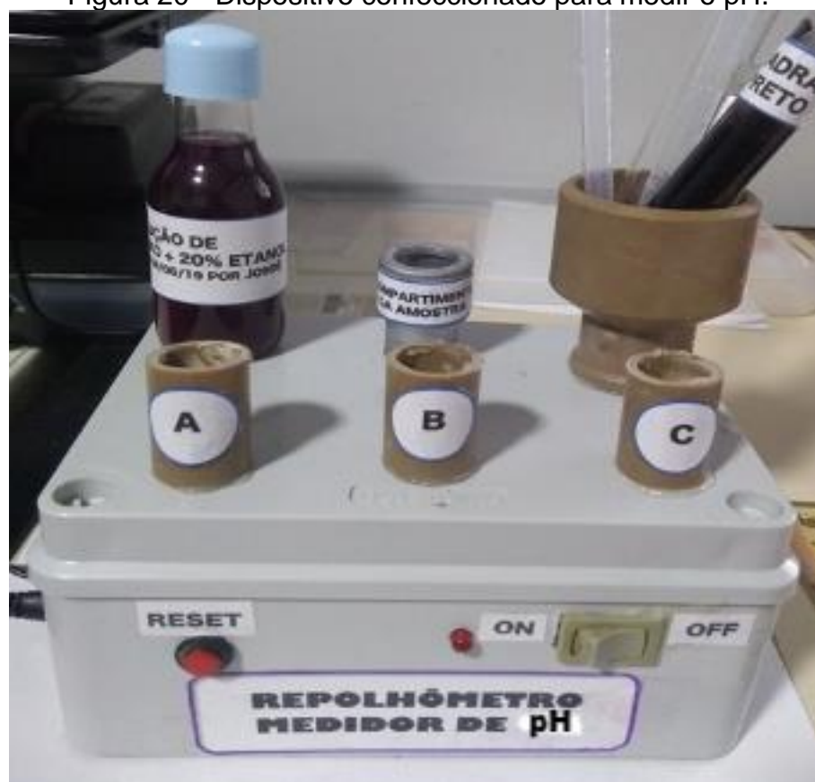
Figura 20 - Dispositivo confeccionado para medir o pH.
