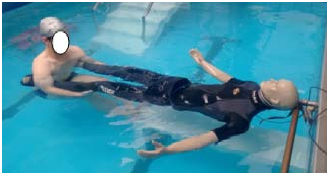
Imagem 1: Situação experimental da técnica individual com pegada pelo tornozelo do protótipo humano, o qual está fixo pela parte superior. Nota-se a utilização do banco redutor de profundidade para apoiar os pés do terapeuta.
