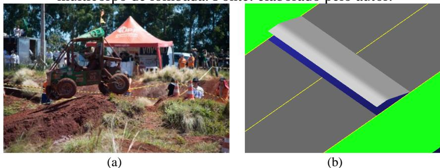
Figura 7 – (a) Obstáculo de vala no BAJA Sul 2019 e (b) modelo multicorpo de vala. Fonte: elaborado pelo autor.
