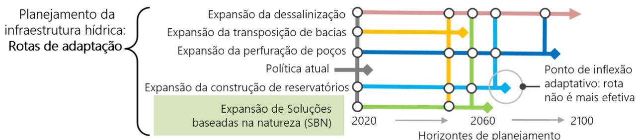
**Figura 5** – Rotas de adaptação da expansão da infraestrutura hídrica, baseadas na proposta de Haasnoot *et al.*(2012).
