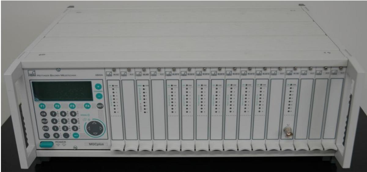
**Figura 28: Unidade de aquisição de dados**
