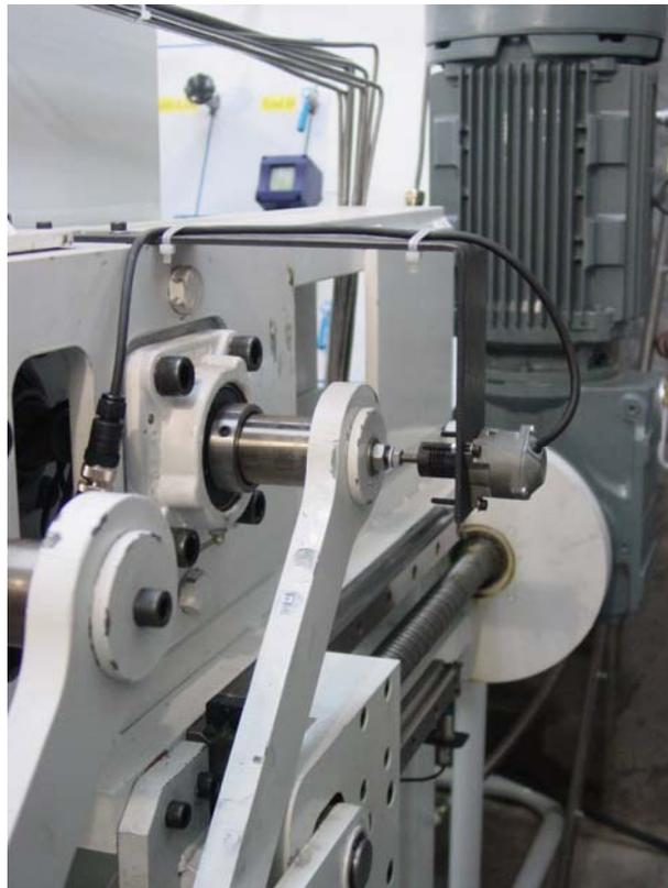
**Figura 27: Encoder (medição do ângulo) no 1º eixo (próximo ao moto redutor)**
