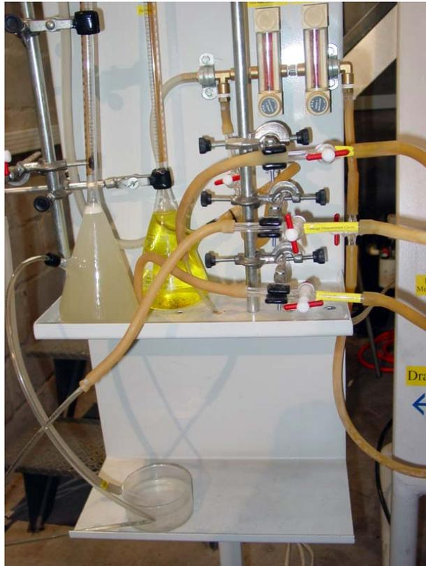
**Figura 39: Sistema de detecção e medição de vazamentos com contador de bolhas, medidores de vazamentos por deslocamento de menisco e rotômetros**
