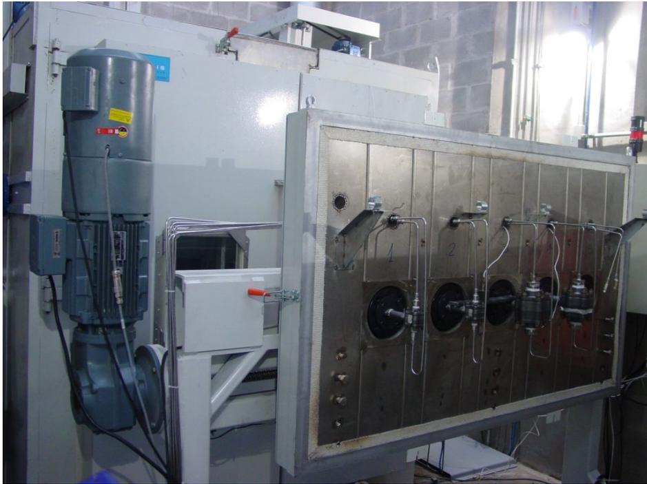
**Figura 25: Parte fixa da câmara, mostrando as válvulas a serem testadas e o moto redutor (em azul à esquerda) para acionamento das mesmas**
