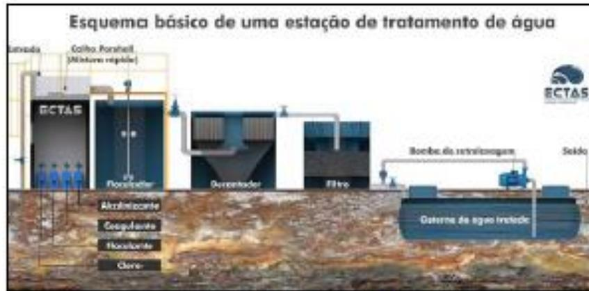
Figura 01. Desenho esquemático da ETA.
