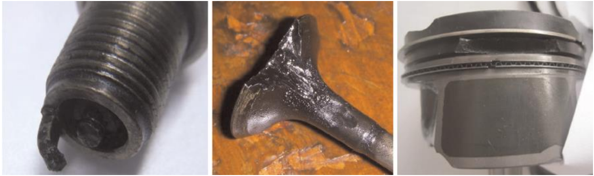
Figura 2.1 - Danos causados pelo knock em componentes do motor [Wang et al., 2014].
