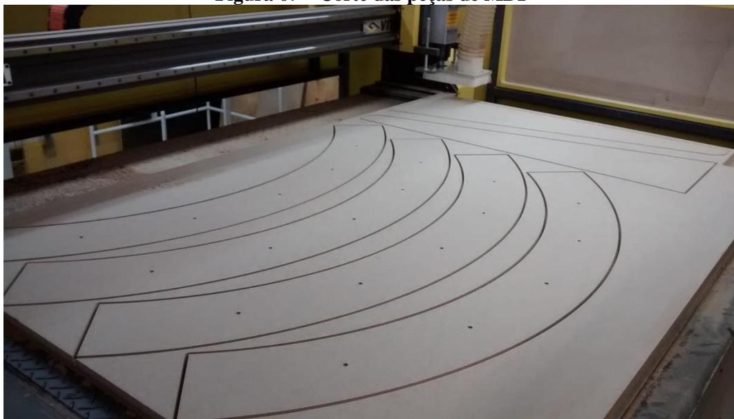
Conforme mencionado anteriormente, o corte das peças de MDF foi realizado em uma fresadora CNC, na qual é possível observar algumas peças na imagem da Figura 67.
