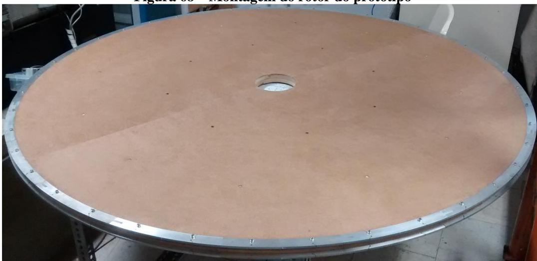
As metades do rotor foram cortadas de modo que fosse possível o encaixe nas suas laterais das peças de alumínio utilizadas para fixação da culatra, de acordo com a Figura 69.
