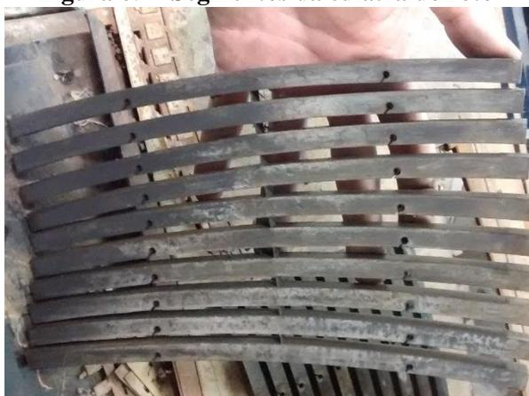
Os segmentos cortados da culatra do rotor são apresentados na Figura 65 e, de acordo com os desenhos do Apêndice A, os mesmos foram retirados de chapas de aço 1020 com 10 mm de espessura. Dessa forma, a culatra do rotor completa é composta por dois segmentos iguais montados em sentidos opostos para que ocorra um travamento com o segmento adjacente.
