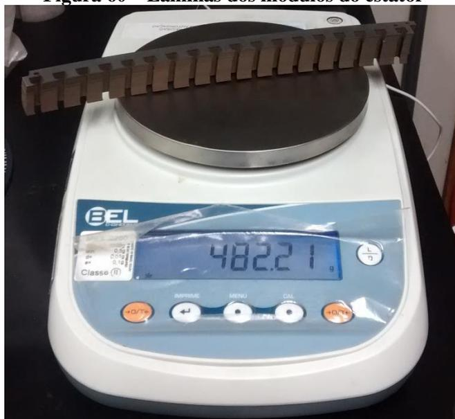
Conforme a imagem da Figura 60, foram pesados quatro pacotes de lâminas após o corte e o valor médio da massa de cada um deles foi de aproximadamente 482 g, de modo que a multiplicação por 20 módulos que compõem o protótipo resulta em uma massa total de aproximadamente 9,64 kg. A valor estimado na fase de projeto para esse módulo é de aproximadamente 10 kg, conforme a Tabela 14, de modo que a diferença entre os valores é de
