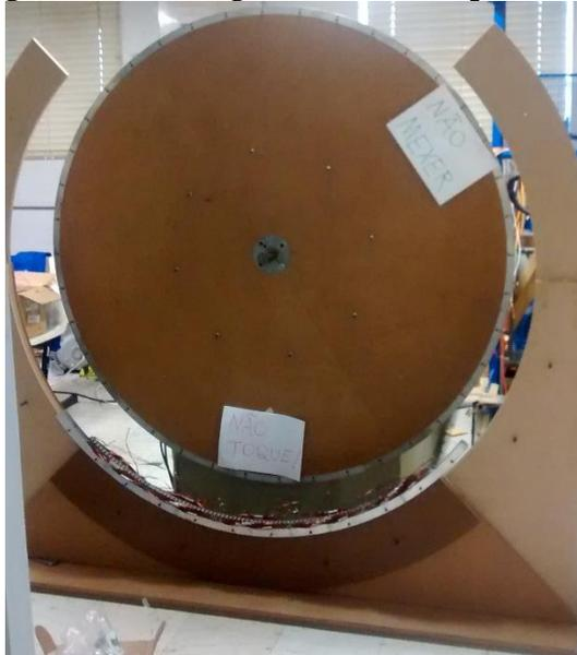
A imagem da Figura 71 apresenta a estrutura de sustentação e o protótipo do gerador síncrono completamente montados.
