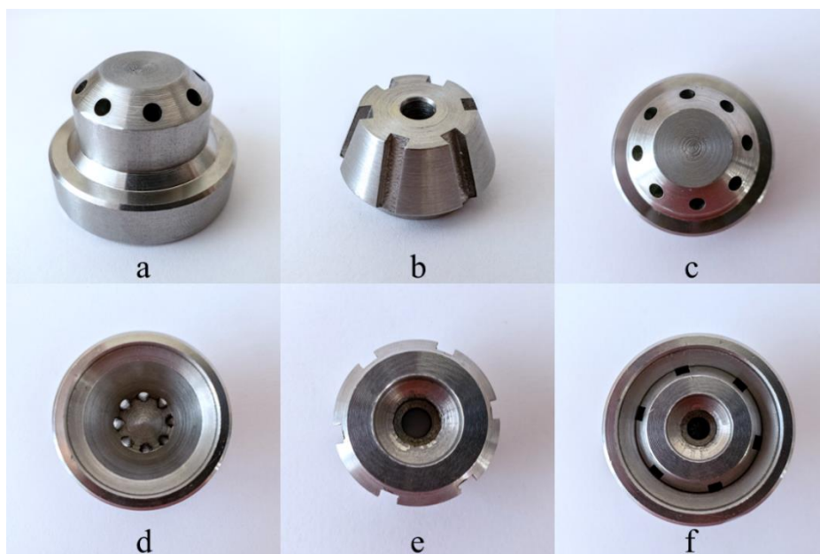
Figura 5.10: Bico Injetor IMCA fabricado: (a) vista da peça externa; (b) vista da peça interna; (c) vista superior do bico injetor; (d) vista inferior da peça externa mostrando detalhes na parte interna do encaixe e da câmara de mistura; (e) vista inferior da peça interna; (f) vista inferior do bico injetor montado mostrando o encaixe das peças.
