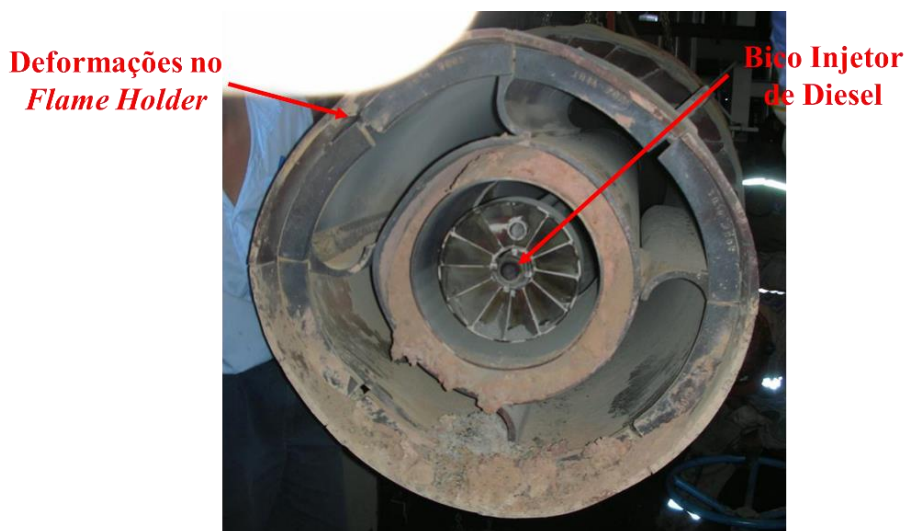
Figura 1.1: Deformações por altas temperaturas no flame holder do queimador principal. A imagem representa apenas uma parte do queimador principal (tubo de ar primário e ar central).
