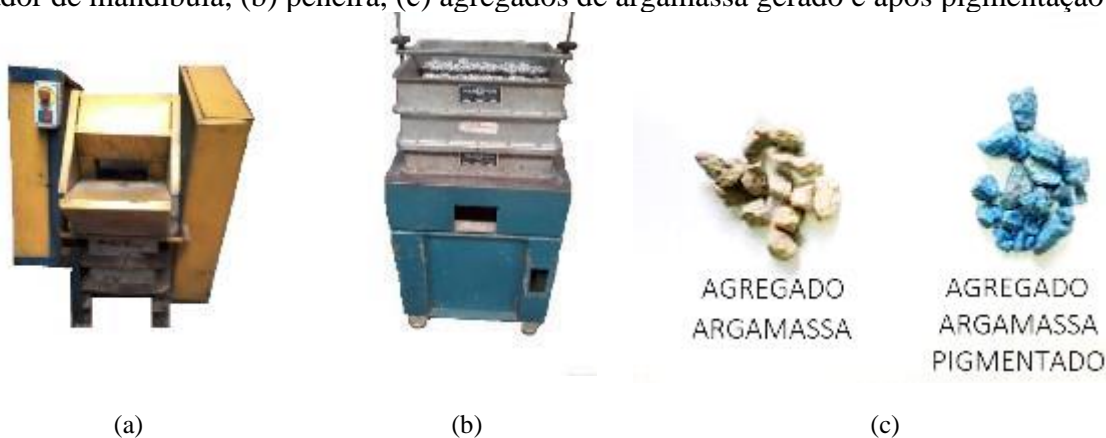
Figura 19 – Equipamentos e materiais utilizados para a geração e caracterização dos RCD. (a) britador de mandíbula, (b) peneira, (c) agregados de argamassa gerado e após pigmentação
