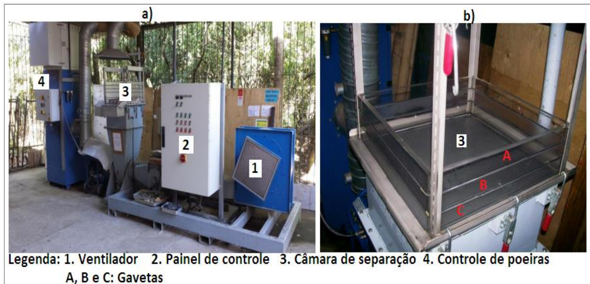
Figura 15: Jigue pneumático modelo AllAir® S-500. (a) Esquema geral (b) detalhe do compartimento de separação do jigue, dotado de gavetas sobrepostas de Plexiglass. Fonte: Adaptado de AMBRÓS (2017)
