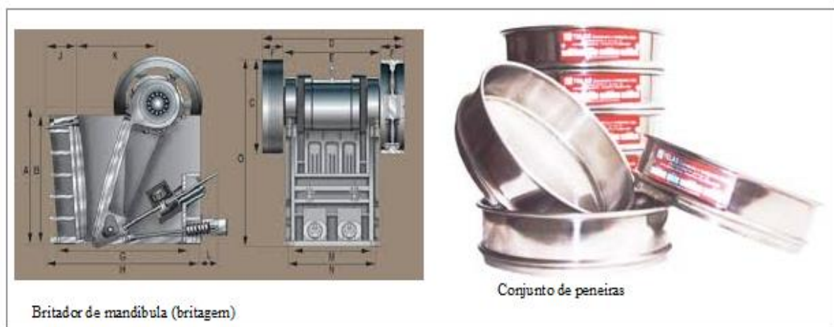
Figura 20: Tipo de britador e peneiras usados para a britagem e peneiramento das amostras.
