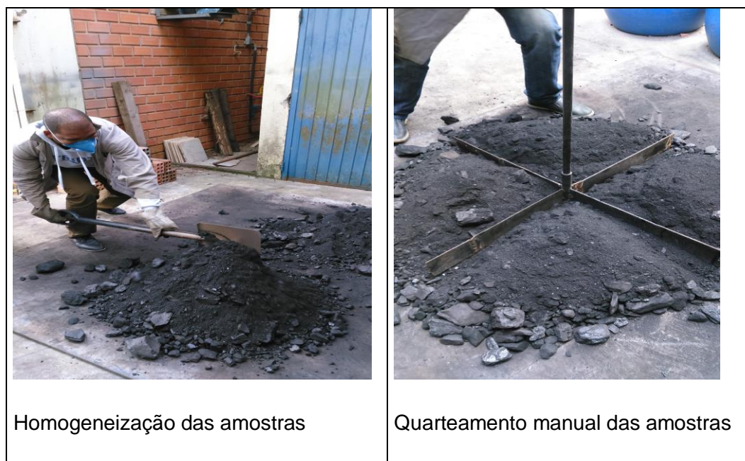
Figura 12: Homogeneização das amostras (Esq.) Quarteamento das amostras (Dir) Fonte: O Pesquisador
