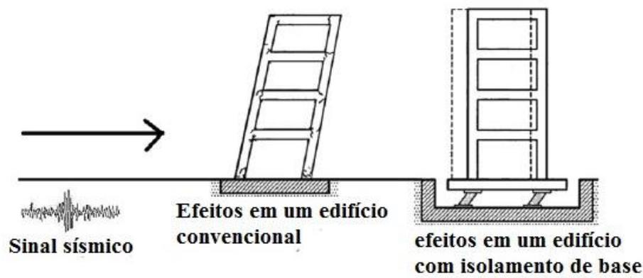
Figura 2.5 - Efeito sísmico em um edifício com isolamento de base. [Adaptada de Romo, 2012]
