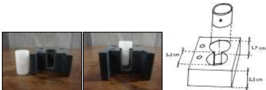
Fig. 13. Imagens do sistema da técnica de PLB (A e B) e o modelo (C) para construção das câmaras onde os experimentos são realizados. A câmara com os compartimentos cis e trans é feita de PVC (cloreto de polivinila), e a cubeta onde a abertura é localizada é feita de poliacetal.
