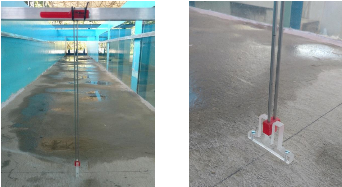
Figura 3.16 – Detalhe da instalação das sondas capacitivas no canal de ensaios do modelo parcial (escala 1:50) e detalhe de fixação junto ao fundo do canal.
