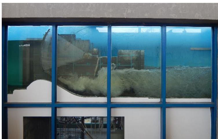
Figura 3.4 – Modelo reduzido parcial do vertedouro da UHE Santo Antônio (escala 1:50).
