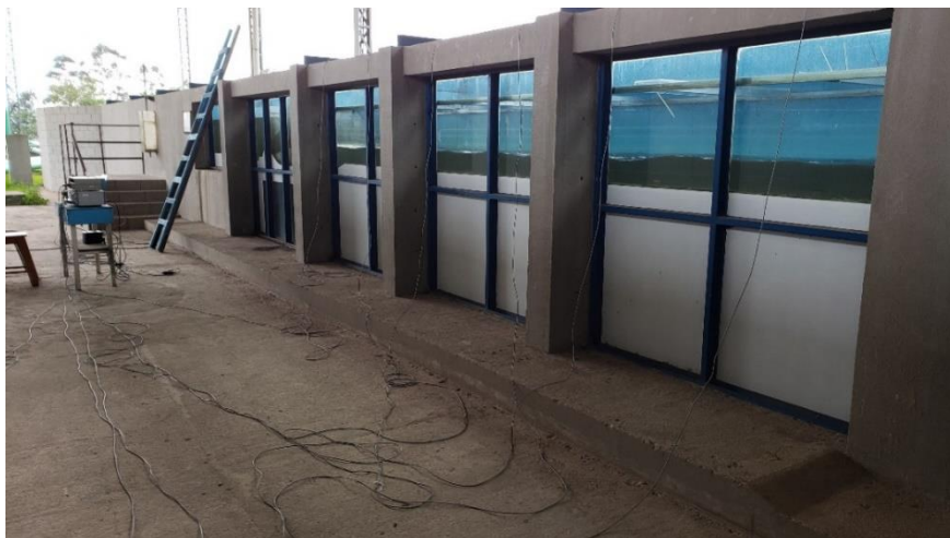
Figura 3.5 – Vista geral do canal de ensaios do modelo reduzido parcial do vertedouro da UHE Santo Antônio (escala 1:50).
