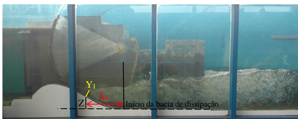
Figura 4.57 – Exemplo da determinação da posição de início do ressalto para Fr_1=4,5 S\% = 1,1 .
