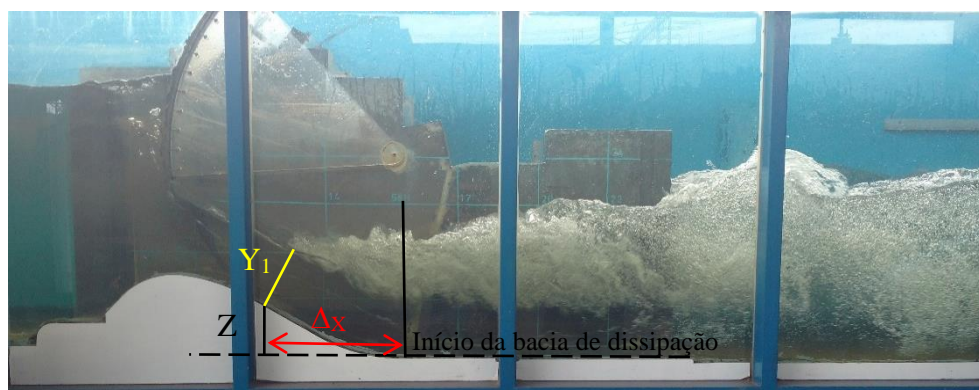
Figura 4.56 – Exemplo da determinação da posição de início do ressalto para Fr_1=2,0 S\% = 1,0 .
