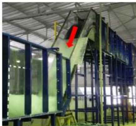
Figura 2.26 – Modelo reduzido do vertedouro em degraus utilizado por Gomes (2018).
