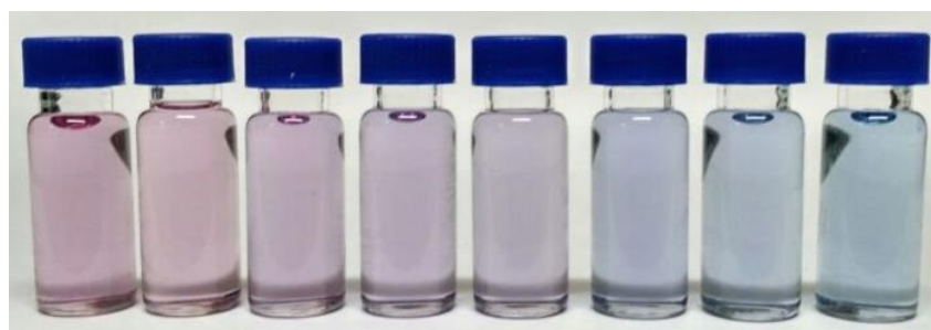
Figura 10. Soluções com corante e gasolina, com diferentes quantidades de etanol anidro. A cor rosa representa a ausência de etanol, a cor violeta uma faixa de 3-18% de etanol e a cor azul uma faixa de 19-50% de etanol adicionado a gasolina. 69
