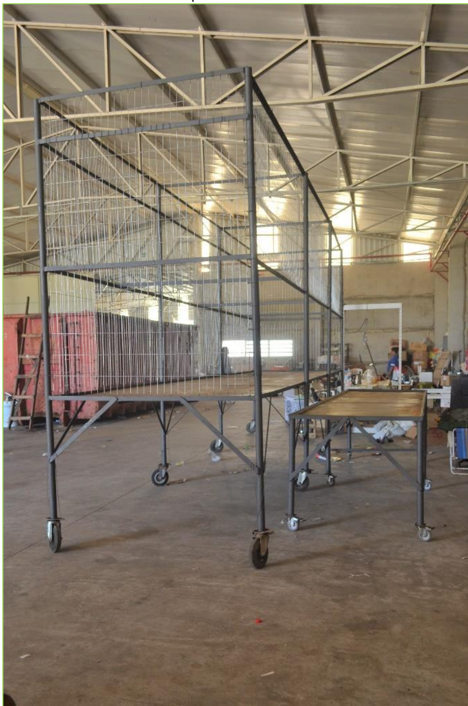
Figura 39 – Estrutura de aço para acomodação e para triagem dos resíduos da coleta seletiva, na Cooperativa Santa Rita
