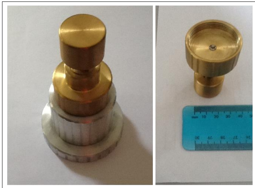
Figura 19 - Dispositivo disparador fabricado nas oficinas do Instituto de Física da UFRGS
