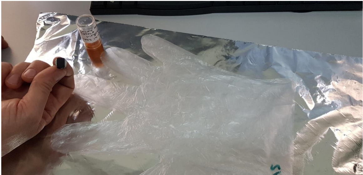
Figura 15- Fotografia da coleta do GSR/NTA da luva utilizada durante o disparo. O stub com a fita de carbono e a embalagem para amostra estão à esquerda da figura.
