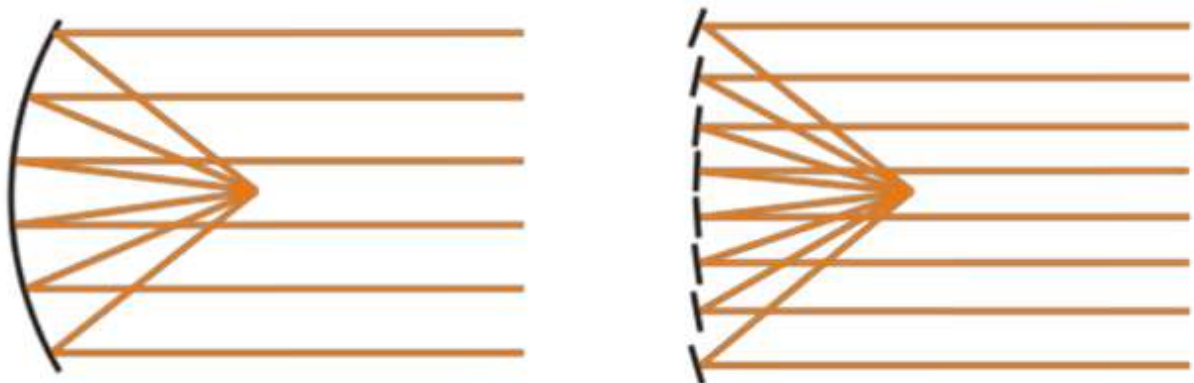
Figura 2.1 - Comparação entre as lentes convencional e Fresnel [Adaptado de Günther, 2011].
