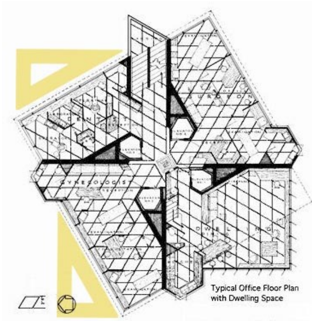
Fig. 7. A coincidência entre os ângulos de projeto e os das ferramentas de desenho de Frank Lloyd Wright. Evidência de implicações que o uso e familiaridade com determinado meio de representação tiveram sobre a concepção wrightiana. É claro que também há uma lógica por trás da padronização de determinada ferramenta que responde ao uso que lhe foi dado ao longo de gerações. Nesse sentido, cabe lembrar a observação de Juhani Pallasmaa (2013, 50) de que “As ferramentas evoluem gradualmente por meio de um processo de pequenas melhorias, uso e rejeição” e que “As melhores ferramentas são o resultado de uma evolução anônima e atemporal”.
