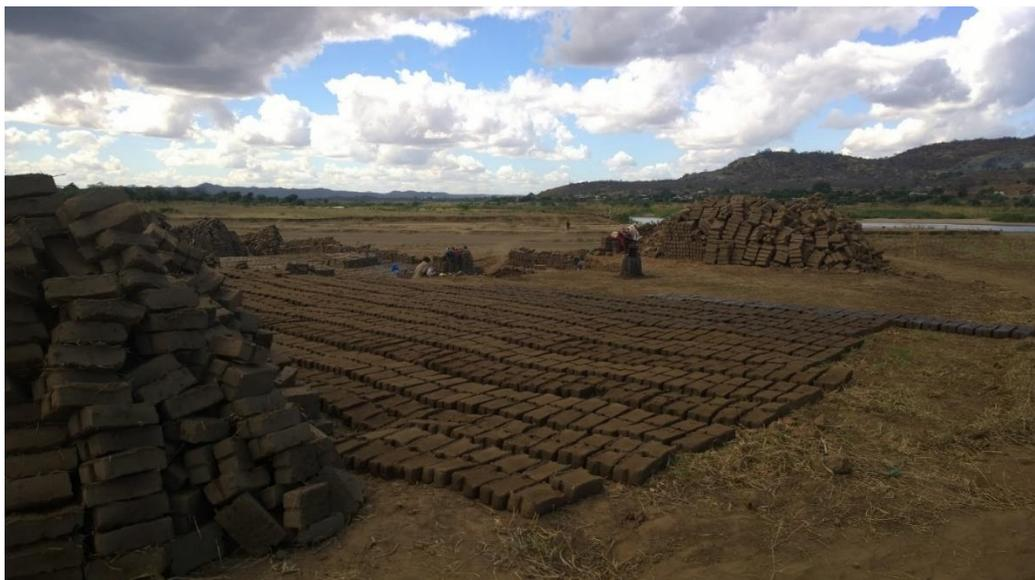
Figura: 63: produção de tijolos ao longo da margem sul do rio Rovúbwè.
