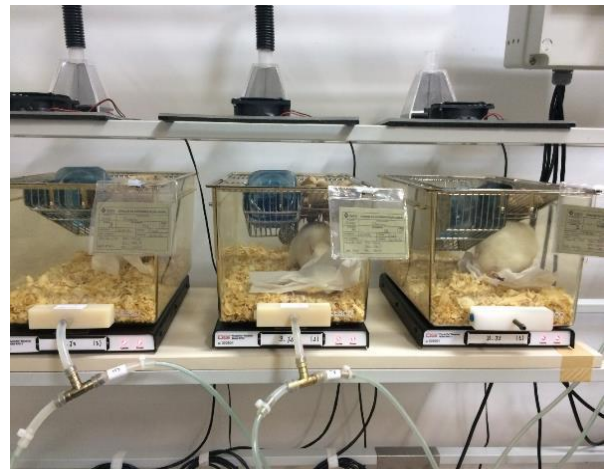
Apêndice 2. Imagens do sistema de hipóxia intermitente desenvolvido por nosso grupo de pesquisa juntamente com o sistema de telemetria.
