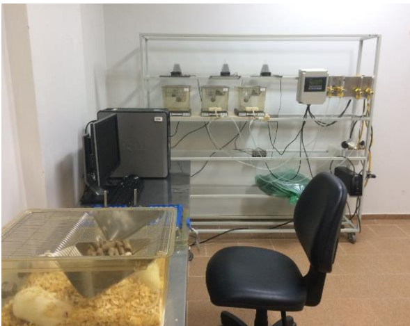
Apêndice 2. Imagens do sistema de hipóxia intermitente desenvolvido por nosso grupo de pesquisa juntamente com o sistema de telemetria.
