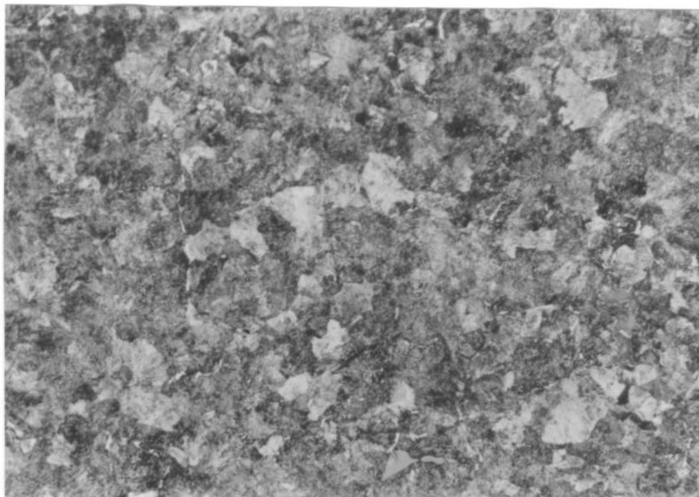
Fig. 30 - Microestrutura próxima a pista de rolamento da roda americana, amostra 8 (AST). Estrutura de perlita fina. Luz polarizada. Ataque de nital 2%. (500x)
