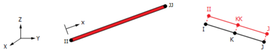
Figura 5.6 – Elemento Reinf264 associado ao elemento base Beam189 .
