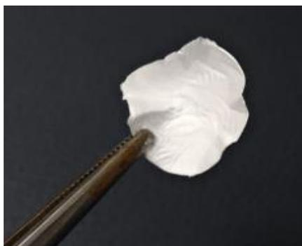
**Figura 6:** Aspecto macroscópico das estruturas de policaprolactona obtidas a partir da técnica de eletrofiação (Laboratório de Hematologia e Células-tronco, Faculdade de Farmácia, UFRGS).
