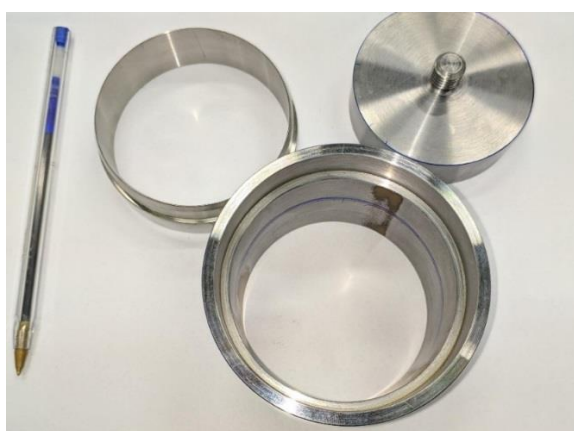
Figura 32: Expansão unidimensional, molde cilíndrico 7 x 2,5 cm e prolongador com pistão confeccionados para moldagem.
