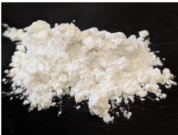
Figura 28: Fibra moída após peneiramento em uma malha #200 ( d < 0,075 mm).
