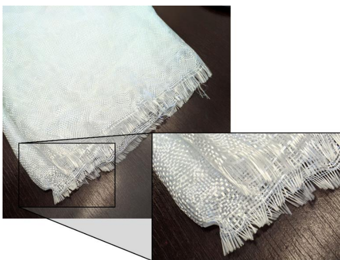
Figura 24: Fibra de vidro comercializada no formato de tecido.
