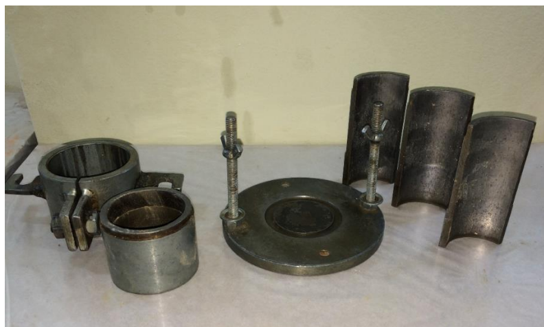
Figura 29: Molde cilíndrico tripartido utilizado para confecção dos corpos-de-prova de 5 x 10 cm.
