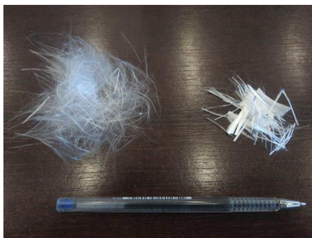
Figura 25: Nessa ordem, fibras desfiadas com auxílio de ar comprimido e, fibras cortadas com 24 mm de comprimento.
