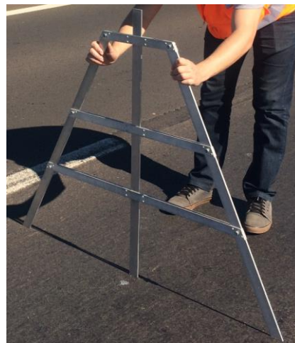
Figura 61 – Treliça de alumínio utilizada na medição dos afundamentos nas trilhas de roda.
