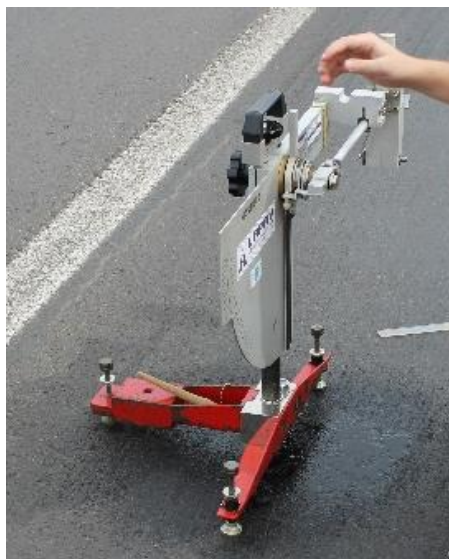
Figura 62 – Pendulo Britânico utilizado para determinar a resistência à derrapagem.
