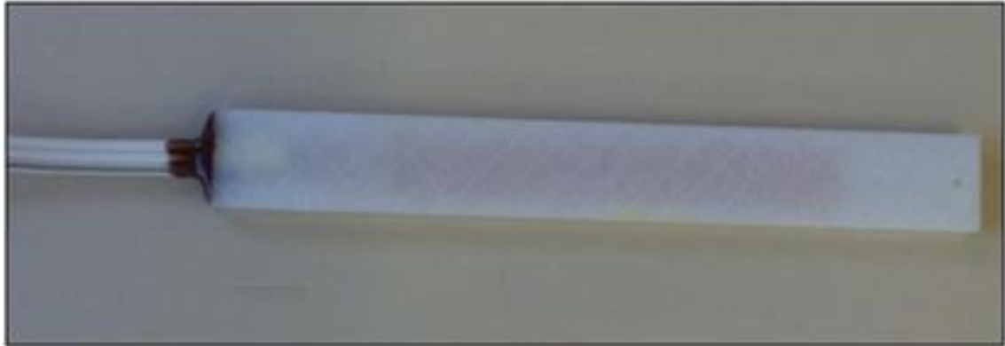
Figura 24 – Sensores de deformação do tipo KM-120-120-H2-11-W1M.
