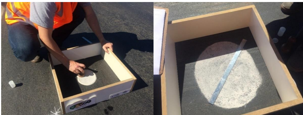
Figura 63 – Ensaio de mancha de areia.
