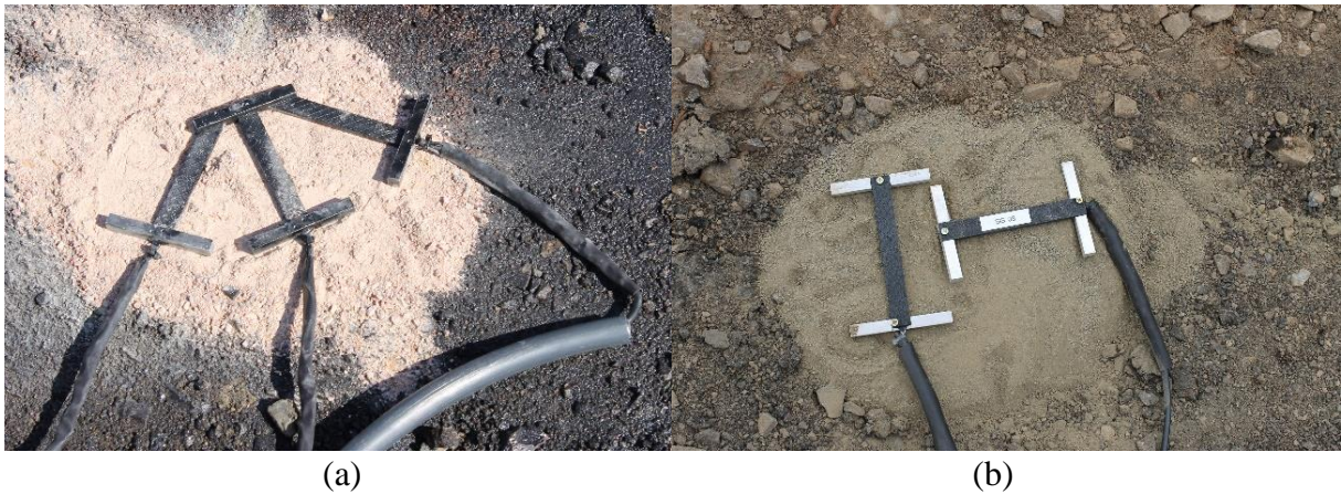
Figura 25 – Extensômetros instalados no topo da camada de base: conjunto de extensômetros em forma de roseta (a) e conjunto com um extensômetro no sentido longitudinal e outro no sentido transversal (b).
