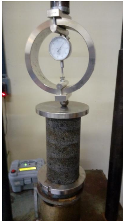
Figura 26: Equipamento para o ensaio de resistência à compressão simples
