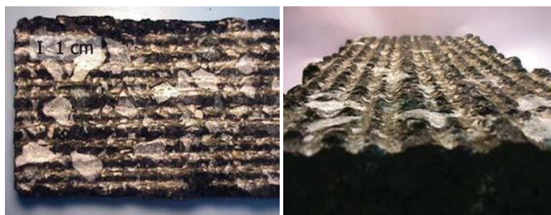
Figura 1: Superfície de uma placa fresada (BONFIM, 2007)
