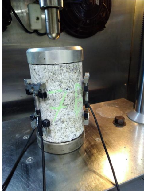
Figura 33: Execução do ensaio de módulo complexo
