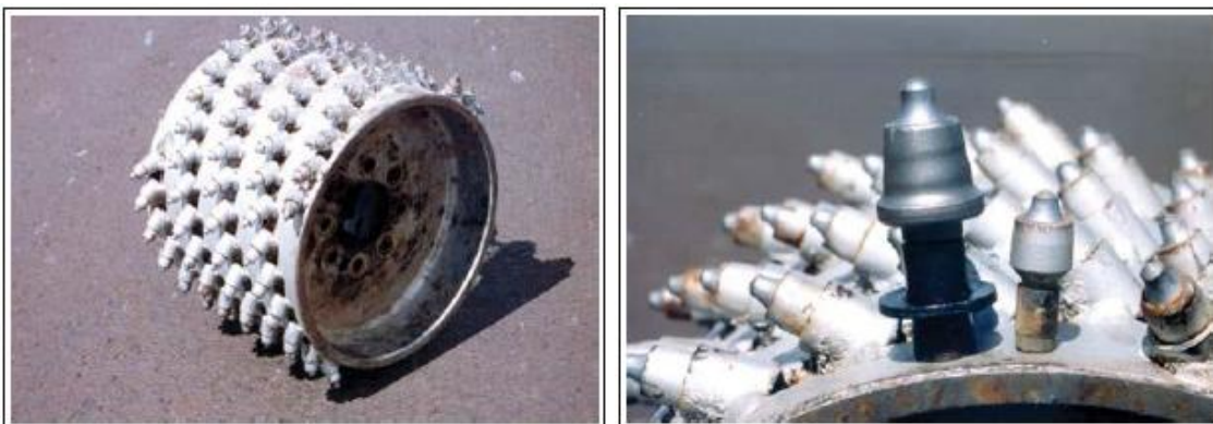
Figura 3: Cilindro de microfresagem (à esquerda) e uma comparação entre os dentes de fresagem padrão e de microfresagem (à direita) (BONFIM, 2007)
