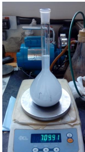
Figura 21: Ensaio de Picnômetro
