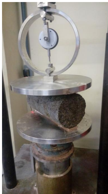
Figura 27: Equipamento para o ensaio de resistência à tração por compressão diametral
