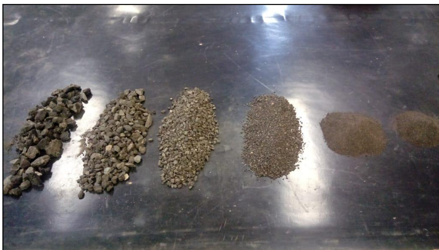
Figura 15: Granulometrias de RAP utilizadas na pesquisa (passantes na peneira n.1”, n.3/8”, n.4, n.10, n.40 e n.200)
