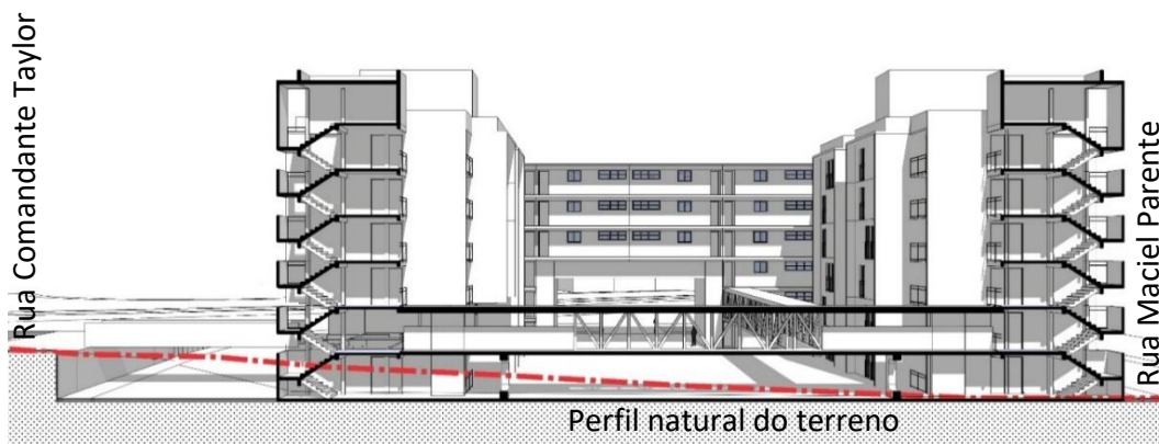
Figura 125 – Corte transversal no conjunto mostrando o acesso localizado no segundo pavimento
