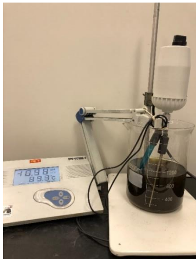
Figura 4.3 – Procedimentos de síntese do óxido-hidróxido de ferro a) acompanhamento do valor de pH e agitação constante b) filtração a vácuo c) secagem em estufa d) destorroagem em pilão
