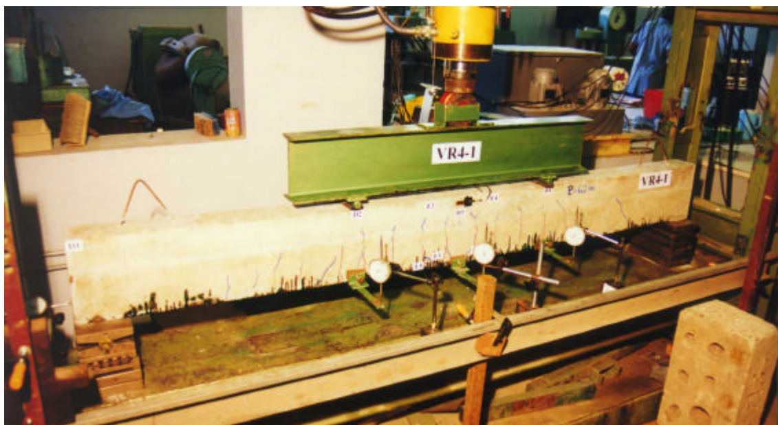
FIGURA 6.39 - Ruptura da viga reforçada com uma camada
