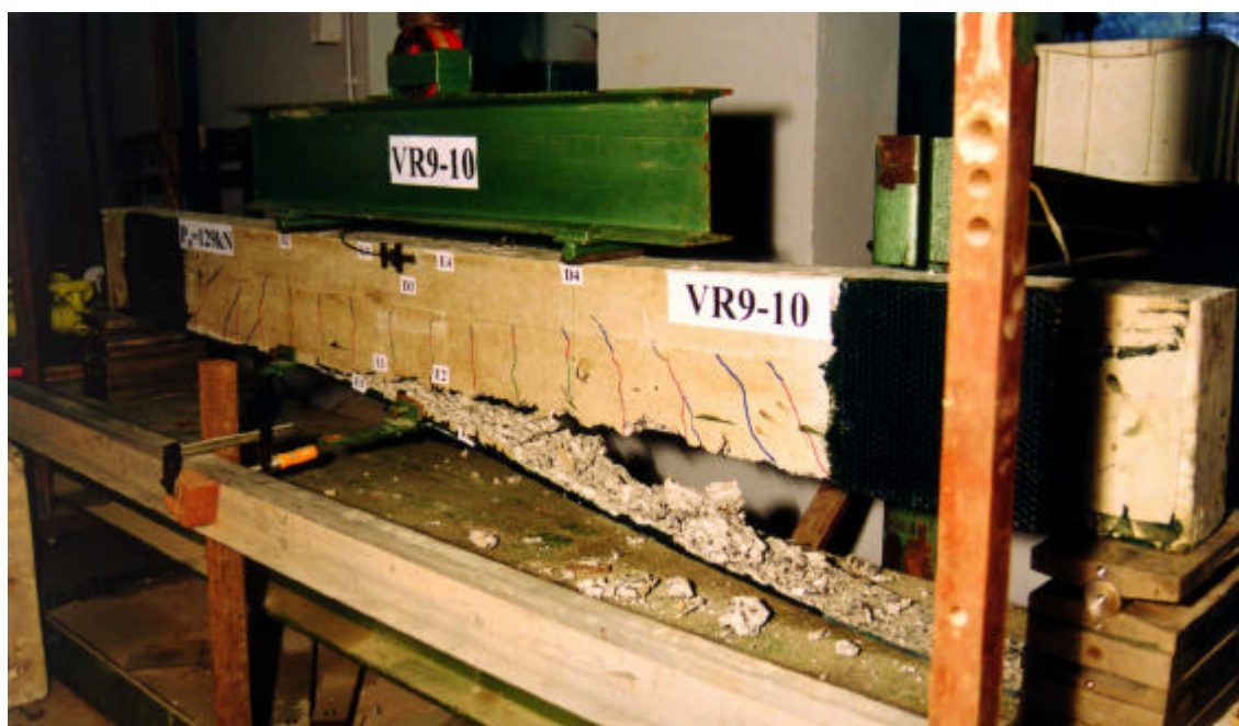
FIGURA 6.45 - Ruptura por descolamento na viga reforçada com dez camadas
