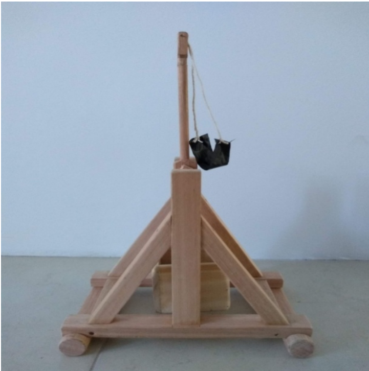
Figura 6 – Trebuchet miniatura construído com madeira (vista lateral).
