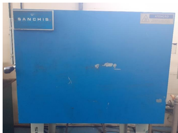
Figura 35. Forno de marca SANCHIS, modelo HM12, utilizado para a simulação dos ciclos de tratamento térmico no presente estudo.
