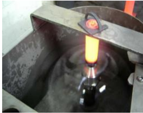
Figura 44. Corpo de prova aquecido e posicionado no equipamento resfriador, recebendo jato d'água em sua extremidade para realização do ensaio Jominy. Fonte: Cedida por Gerdau Aços Especiais Charqueadas.
