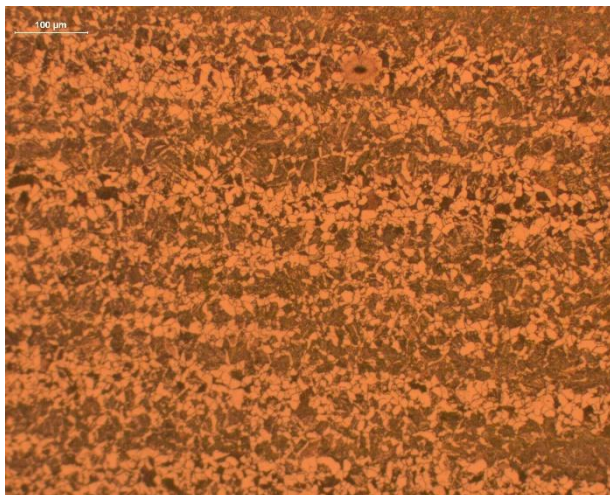
Figura 74. Material submetido ao Ciclo 1. Bandeamento leve. Região do núcleo. Ataque: Nital 2%. Objetiva de 100x.
