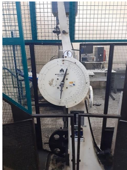
Figura 48. Equipamento MFL – PSW 30/15, utilizado para avaliação de resultados de impacto Charpy para o aço DIN 19CrNi5.
