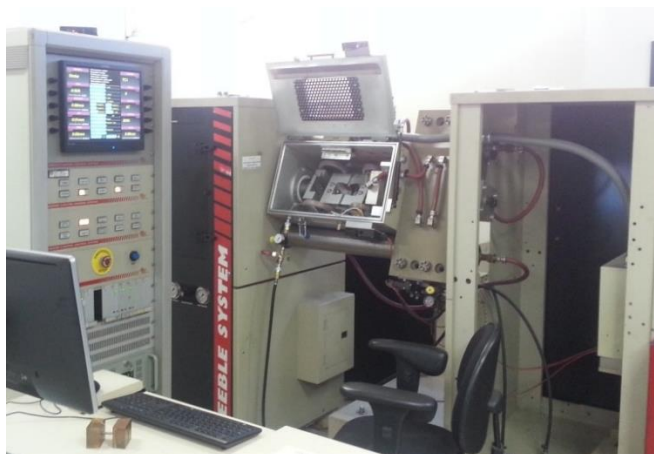
Figura 38. Simulador Termomecânico Gleeble 3500. Fonte: Cedida por Gerdau Aços Especiais Charqueadas.
