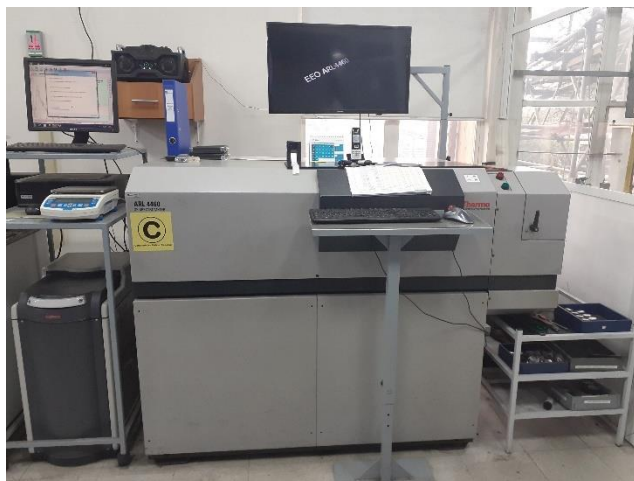
Figura 36. Espectrômetro de Emissão Óptica Modelo ARL – 4460 utilizado para a caracterização de composição química.
