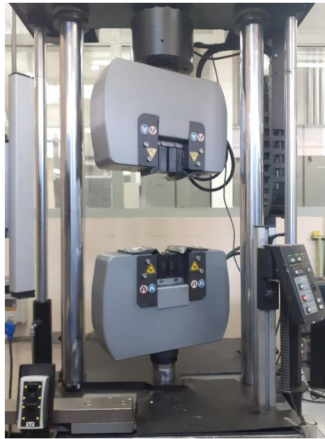
Figura 52. Equipamento Instron Universal – 300LX, utilizado para realização de ensaios de tração para o aço DIN 19CrNi5.
