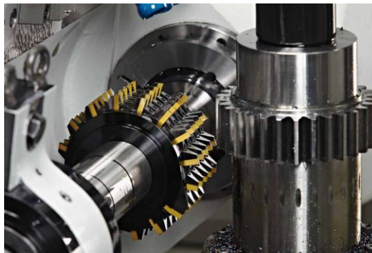
Figura 24. Confeção de engrenagem a partir de operação de fresamento. Fonte: [43].
