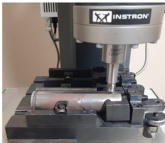
Figura 45. Medição de dureza para os pontos do corpo de prova do ensaio Jominy.
