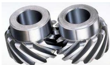
Figura 19. Engrenagens cilíndricas de dentes helicoidais. Fonte: [30].
