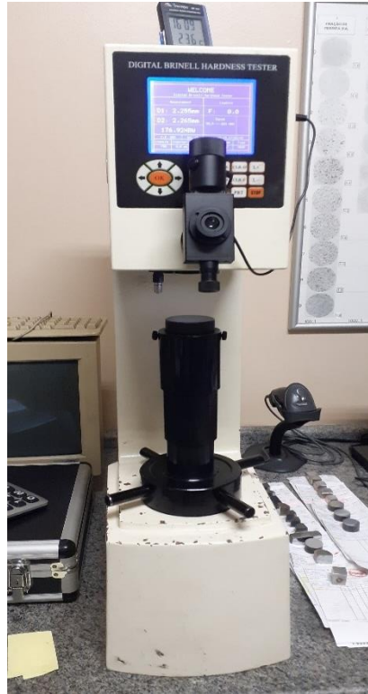
Figura 46. Equipamento para teste de dureza Brinell utilizado no presente estudo.
