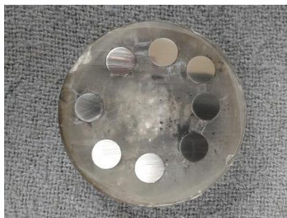
Figura 37. Corpos de prova do ensaio termomecânico embutidos em resina para análise de metalografia.
