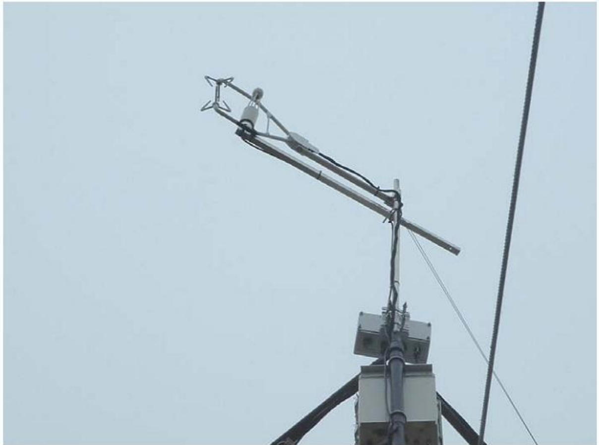
Figura 3 – Sistema de covariância de vórtices: anemômetro sônico e analisador de gás de caminho aberto.
