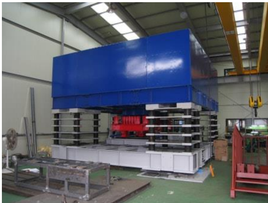
Figura 2.2: Amortecedor de massa sintonizado de 160 toneladas. Disponível em: < http://www.tesolution.com/poscoentower.html > Acesso dia 15 de dezembro de 2019.
