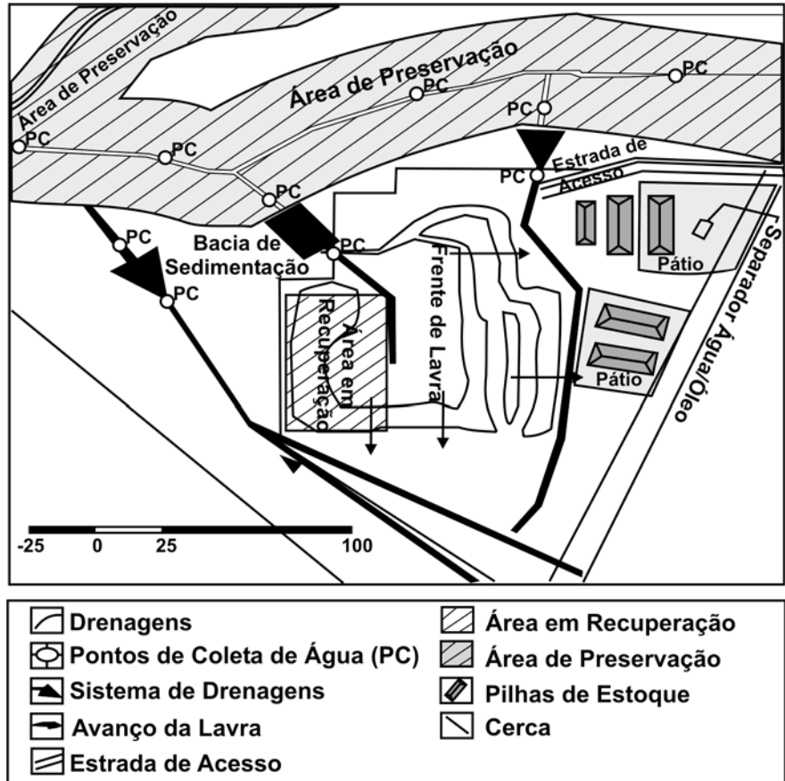
Figura 5 - Desenho esquemático da mina, salientando o sistema de drenagem e os pontos de coleta das amostras de água e a dinâmica da recuperação, onde as áreas em recuperação são a parte posterior ao avanço da lavra.
