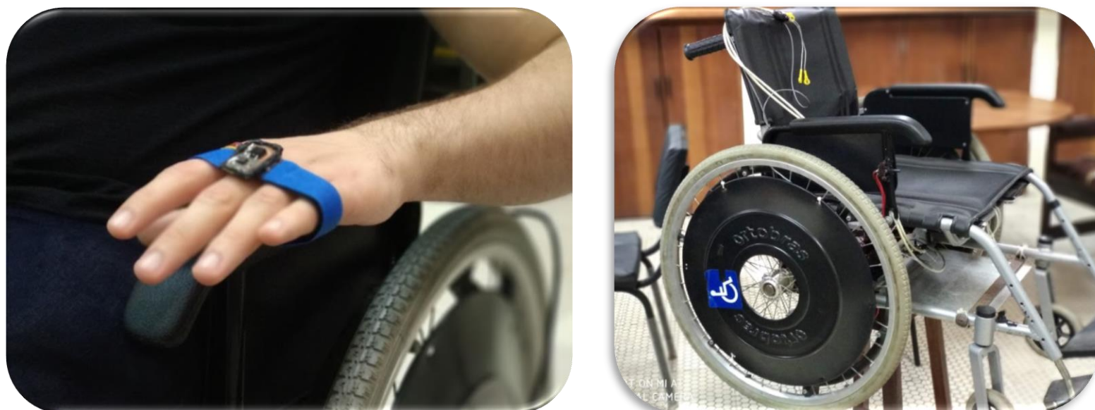
Figura 1: Circuito com acelerômetros e Cadeira de rodas adaptada
